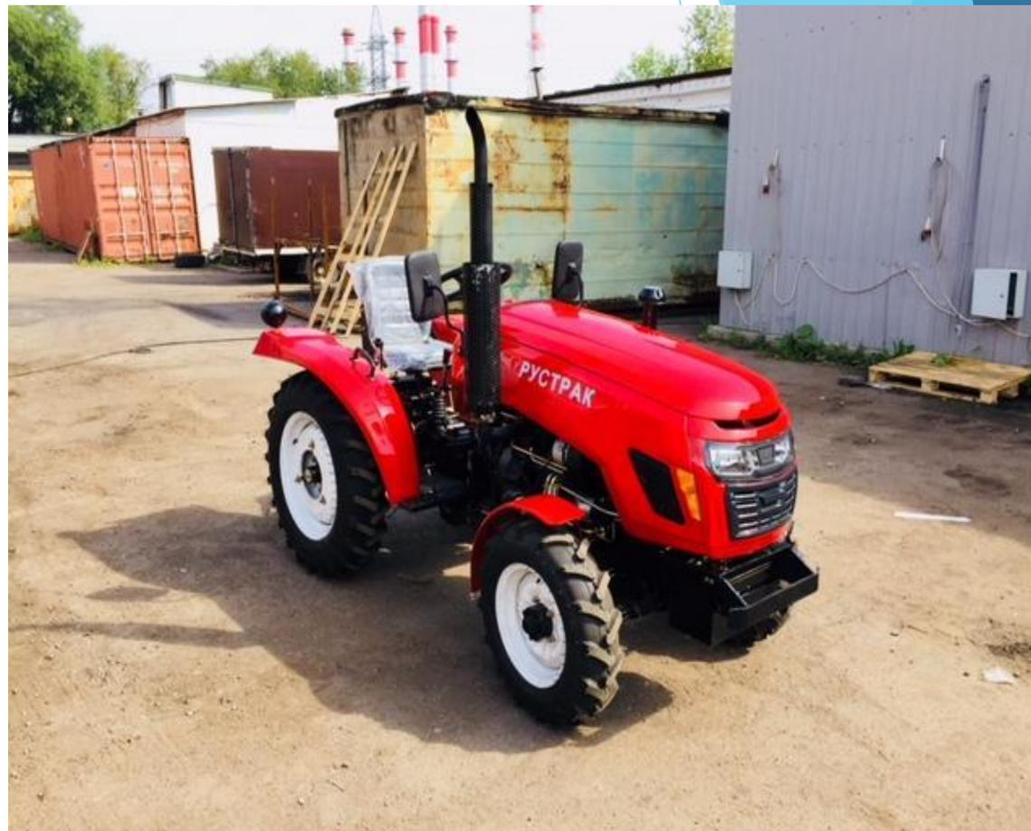
Минитрактор Рустрак-244 – это современная модель средней мощности, с надежным и выносливым трехцилиндровым двигателем модели KM385BT, который имеет прямой впрыск, а также превосходное водяное охлаждение. Техника собирается в России на заводе «РУСТРАК», с использованием импортных и российских комплектующих, проходит обкатку и проверку.
