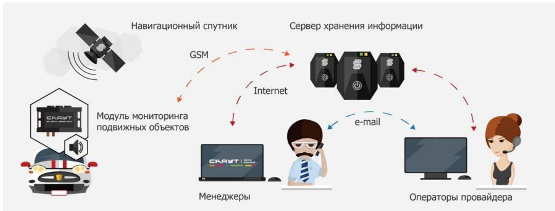
Автомобили оснащаются ГЛОНАСС/GPS-терминалами с устройством звуковой обратной связи для водителя. Сотрудники заказчика имеют доступ к системе через Интернет и/или получают отчеты о нарушениях от внешних операторов.
