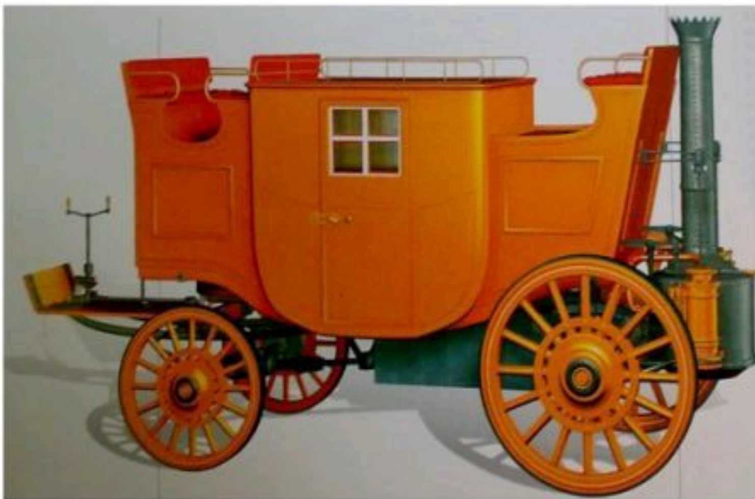
Полноприводный паровик Берсталла и Хилла созданный в 1824 году
