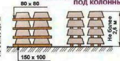
ЦЕНТРИФУГИРОВАННЫЕ ОПОРЫ ВЛ Прокладка 200 x 300 с вырезами
