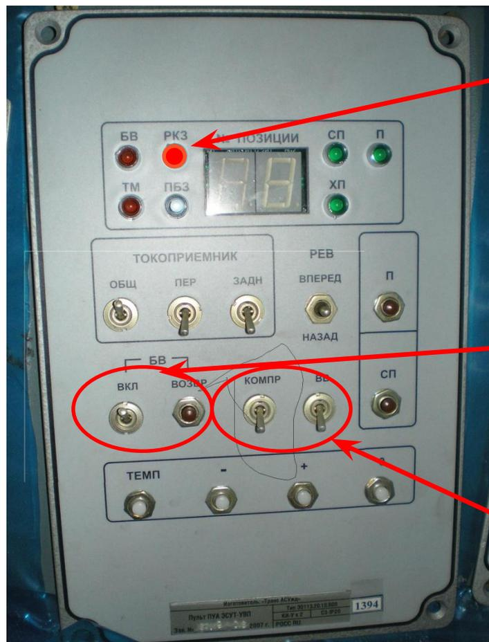
7. На ПУА (пульт управления аварийный) включить тумблера «Токоприемники»: «Общий», загорится светодиод «РКЗ» и включить тумблер нужного токоприемника (там, где закачен воздух в цепи управления), после подъема токоприемника светодиод «РКЗ» погаснет.
