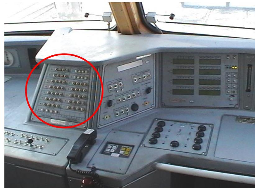
11. Предварительно на асинхронном пульте для исключения поднятия всех токоприемников одновременно тумблер «ОТКЛ. ТОКОПР.» «1» установить в верхнее положение (на 3-х секционном электровозе установить в верхнее положение тумблера «ОТКЛ. ТОКОПР.» «2» и «3».
