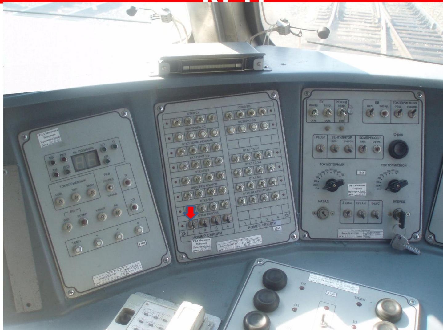
13. Для поднятия оставшихся токоприемников на асинхронном пульте тумблер «ВЫКЛ ТОКОПР./1, 2 или 3» установить в нижнее положение.
