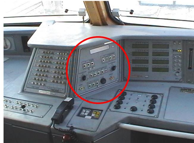
6. Вставить ключ в замок нужного направления на пульте управления и повернуть его в среднее положение;
