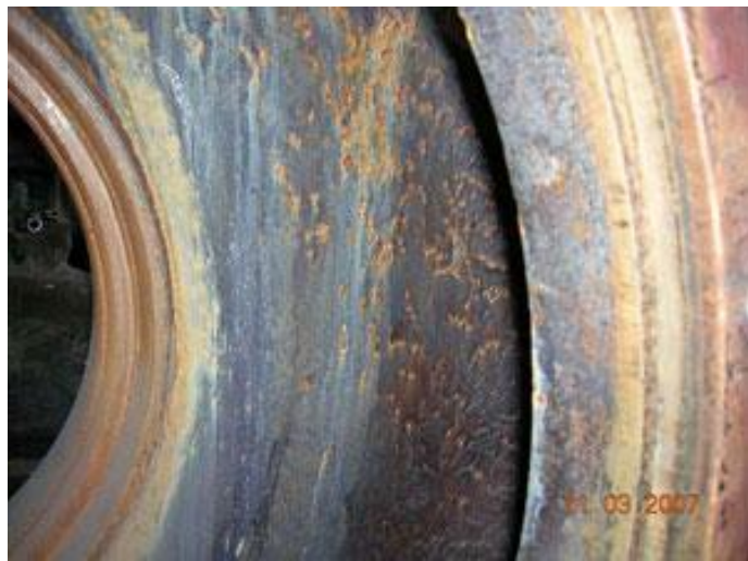
Рис. 1. Кавитация улитки после года работы насоса.
