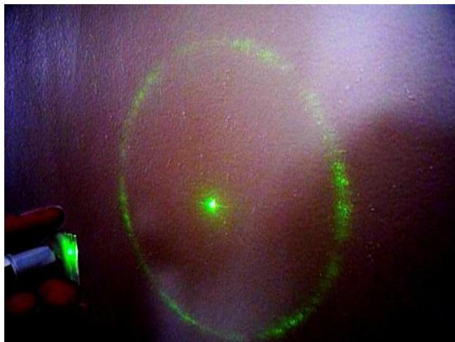
Длина волны лазера 532 нм. Период  $d = 728 \pm 40$  нм, средний диаметр частиц  $D = 841 \pm 46$  нм (согласно АСМ,  $D = 850 \pm 40$  нм)
