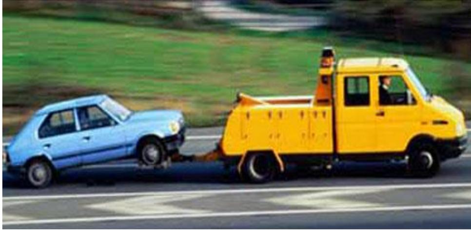
При таком способе разрешается буксировать автомобиль с любой неисправностью, в том числе и с неисправной тормозной системой, и с неисправным рулевым управлением. **Но! Нахождение людей (в том числе и водителя) в салоне буксируемого автомобиля запрещено!**
