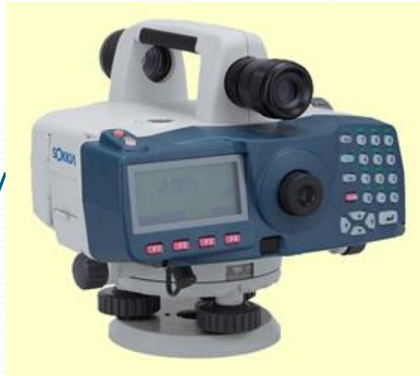
Sokkia SDL1X С.к.п. на 1 км ходу 0,2 мм
