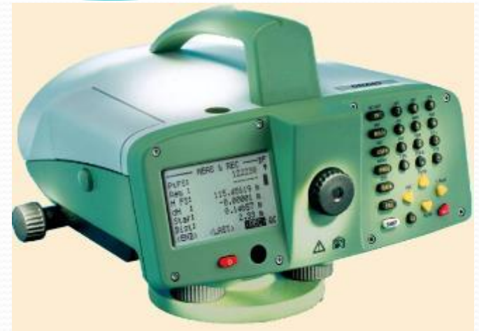
Leica DNA03 С.к.п. на 1 км ходу 0,3 мм
