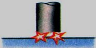
Образование прослойки из жидкого металла
