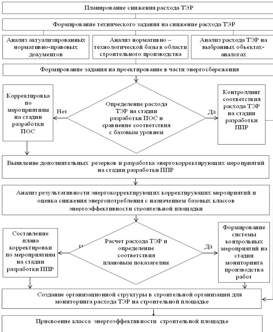
Блок-схема формирования организационно-технологического механизма реализации энергосберегающих мероприятий при возведении объектов монолитного домостроения
