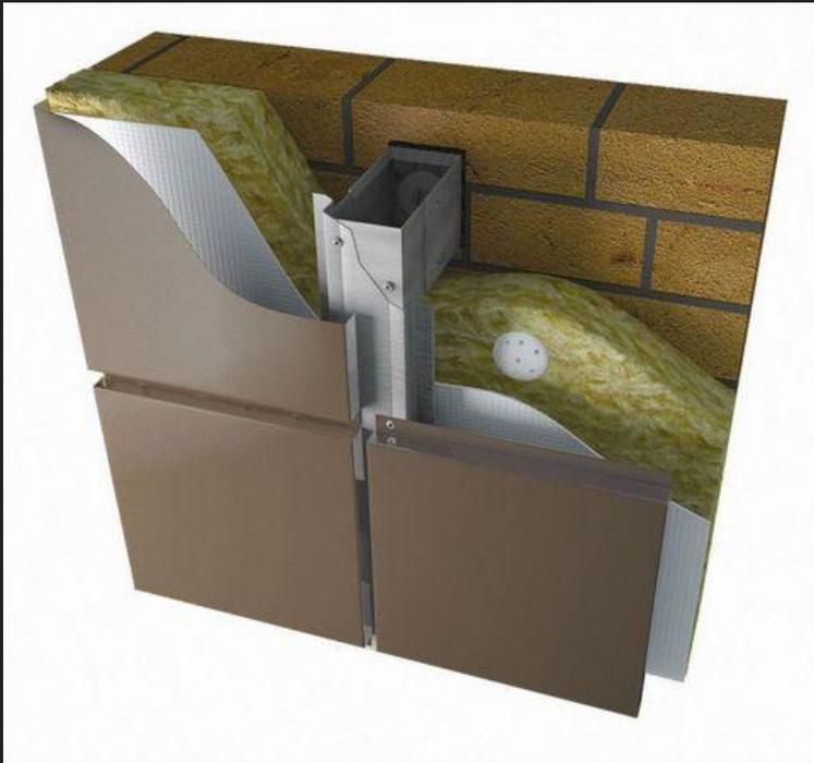
**Металлические фасадные кассеты** представляют собой пластины, произведенные из оцинкованной стали либо из анодированного алюминия загнутых с четырех сторон. Они покрываются методом напыления полимерным слоем, обеспечивающим дополнительную защиту материала.
