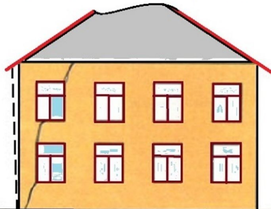
Отклонение стены от вертикали.
