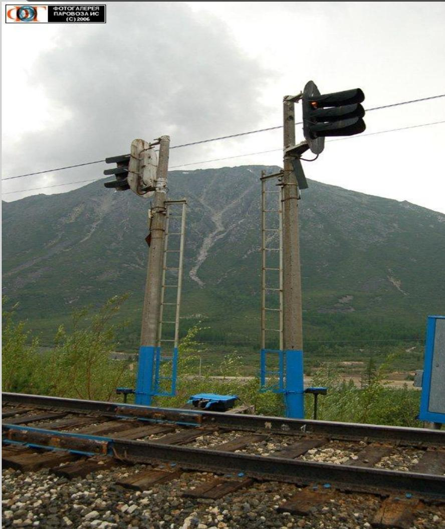
Назначение: регулируют движение поездов на перегонах с АБ
