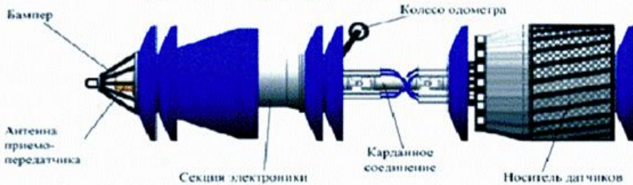
Дефектоскоп внутритрубный ультразвуковой WM 28/32"
