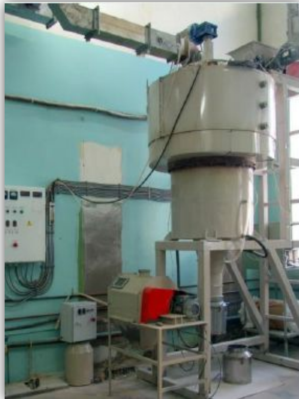
Рис. 1 - Центробежный реактор «Цефлар» барабанного типа
