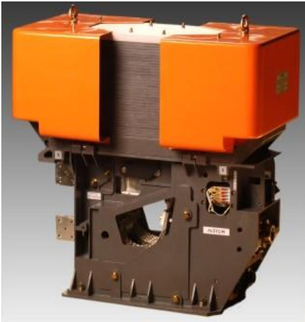
Быстродействующий выключатель ARC 3035 – однополюсный, неполяризованный с электромагнитным управлением и естественным охлаждением, предназначен для защиты оборудования электровоза при работе от контактной сети постоянного тока.
