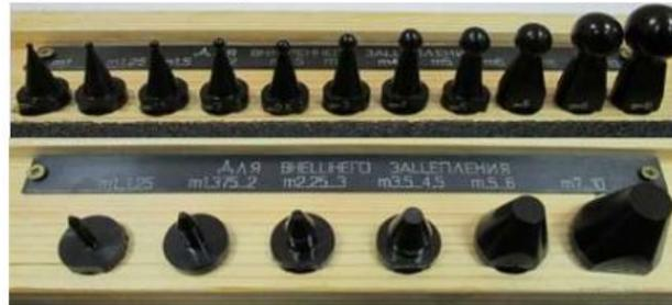
Для контроля направления контактной линии косозубых цилиндрических колес может использоваться биениемер НИИК-1010 (Б-10М) с дополнительной наладкой НИИК-1010.03.
