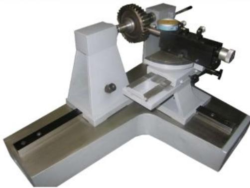
Биение зубчатого венца измеряется с помощью прибора НИИК-1010 (аналог Б-10М), снабженного измерительным наконечником конической формы (угол 40 град.) или с шариком контактным элементом сферической формы, диаметр которого зависит от модуля и угла зацепления. Наконечник последовательно вводится во все впадины колеса и максимальная разность показаний принимается за радиальное биение  $F_{rr}$ .
