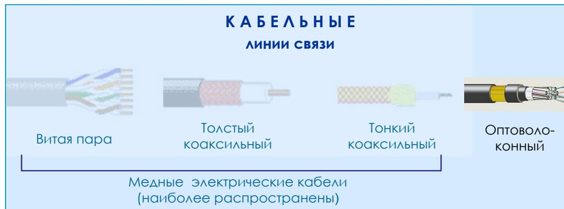
Кабель состоит из проводников, слоев экрана и изоляции. Также в состав кабеля входят разъемы для подключения его к сетевому оборудованию.
