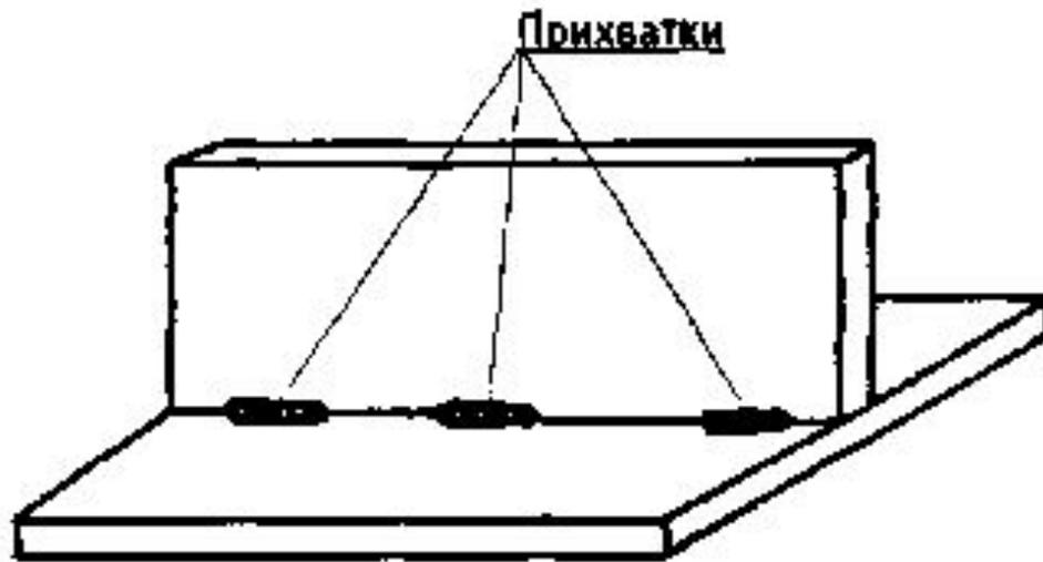
Длина прихваточных швов зависит от протяженности соединения. Наиболее часто применяются прихватки длиной от
