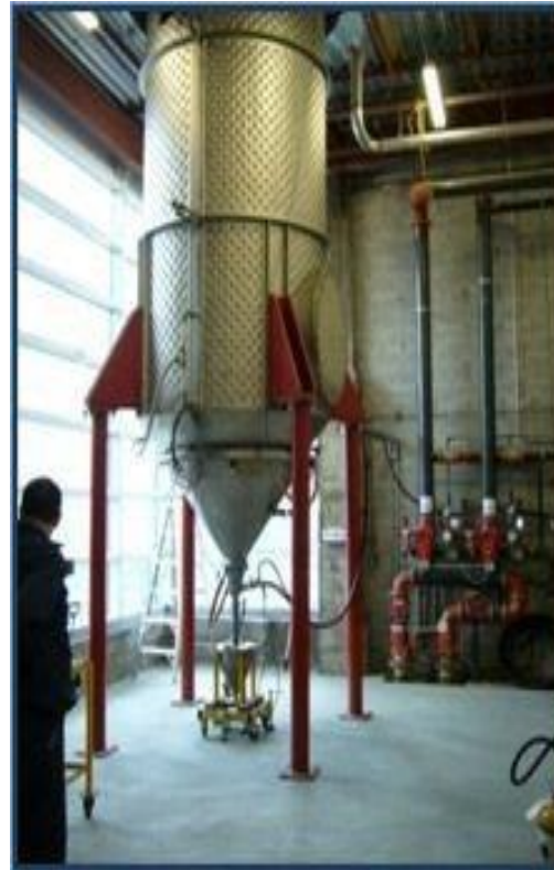
Рисунок 3. Технология Plasma Atomization: а – схема процесса плазменной атомизации; б – атомайзер Raymor
