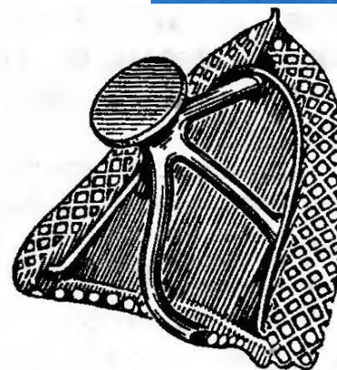
Установка литникобразующих штифтов и создание литниковой системы
