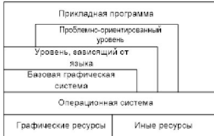
Структура прикладной графической системы, удовлетворяющей сформулированным требованиям
