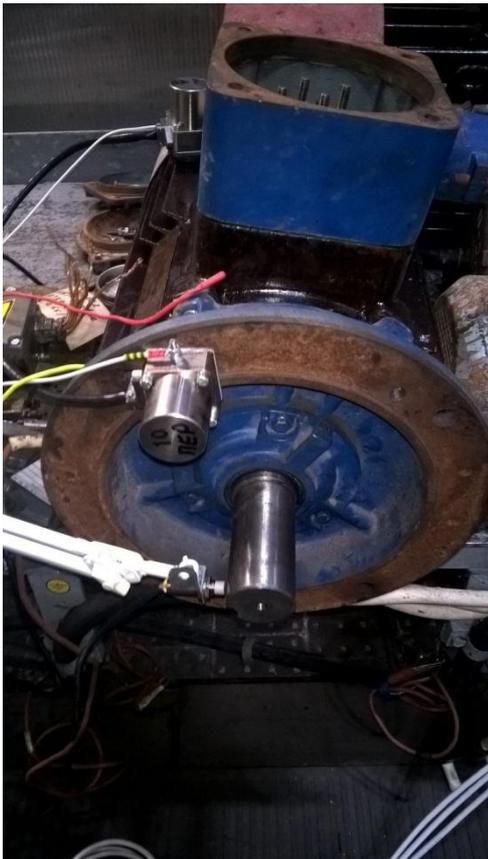
Датчики вибрации и частоты
