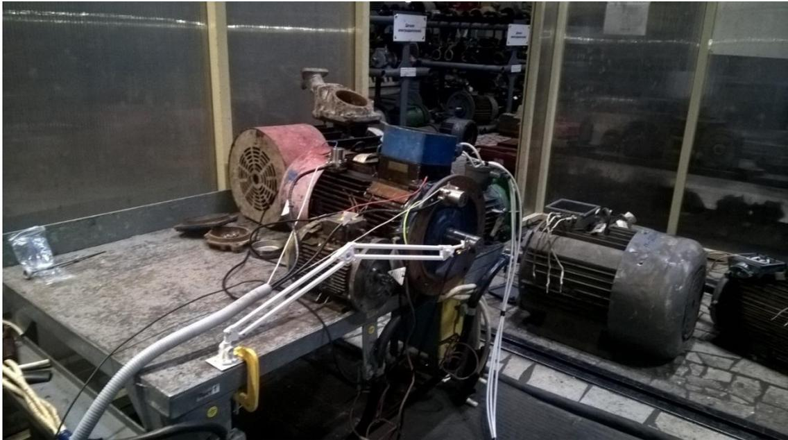
Объект испытания с установленной на нем системой датчиков
