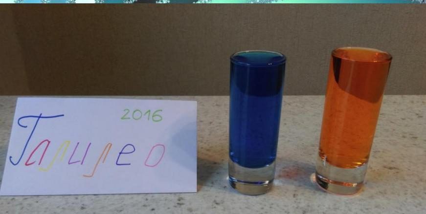
Переворачиваем емкость с горячей водой и ставим на сосуд с холодной водой. Они не смешиваются.
