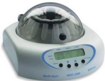
Центрифуга/вортекс Мультиспин MSC-3000 является продуктом спин-микс-спин технологии, предназначенной для “сброса” микро-объемов реагентов на дно пробирки (первое центрифугирование – спин), последующего перемешивания (микс) и повторного сбора реагентов (повторный спин) со стенок и пробки микропробирок. Этот повторяющийся алгоритм операций, имеющий целью снизить ошибки пробоподготовки для ПЦР анализа, производители назвали «смс – алгоритм».
