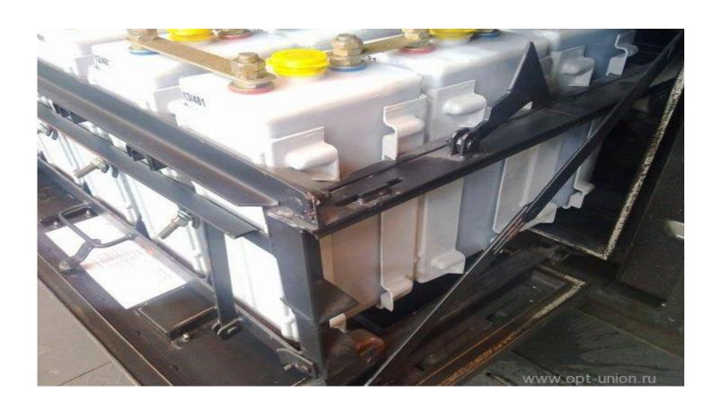
Принцип работы автомобильного щелочного аккумулятора относительно прост. При полной разрядке щелочной аккумуляторной батареи гидроокись никеля взаимодействует ионами щелочного раствора. В результате, образуется гидрат закиси никеля. На минусовом выводе протекает схожий процесс. При этом формируются определенные элементы.
