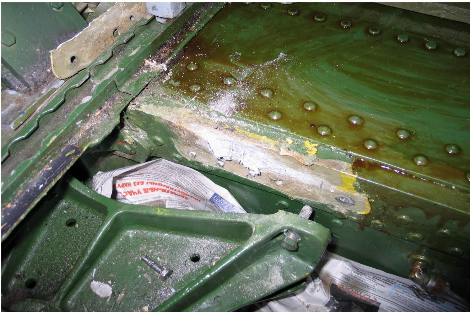
Рис. Расслаивающаяся коррозия вертикальной полки верхнего пояса I лонжерона центроплана (в районе верхнего кронштейна крепления гермовывода элеронов) (самолет Ту-134А)
