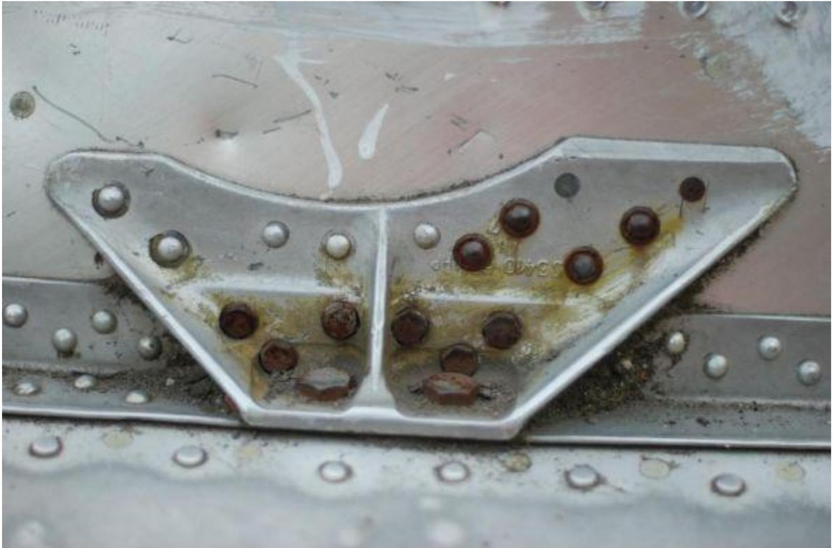
Рис. Коррозия заклепочное соединения
