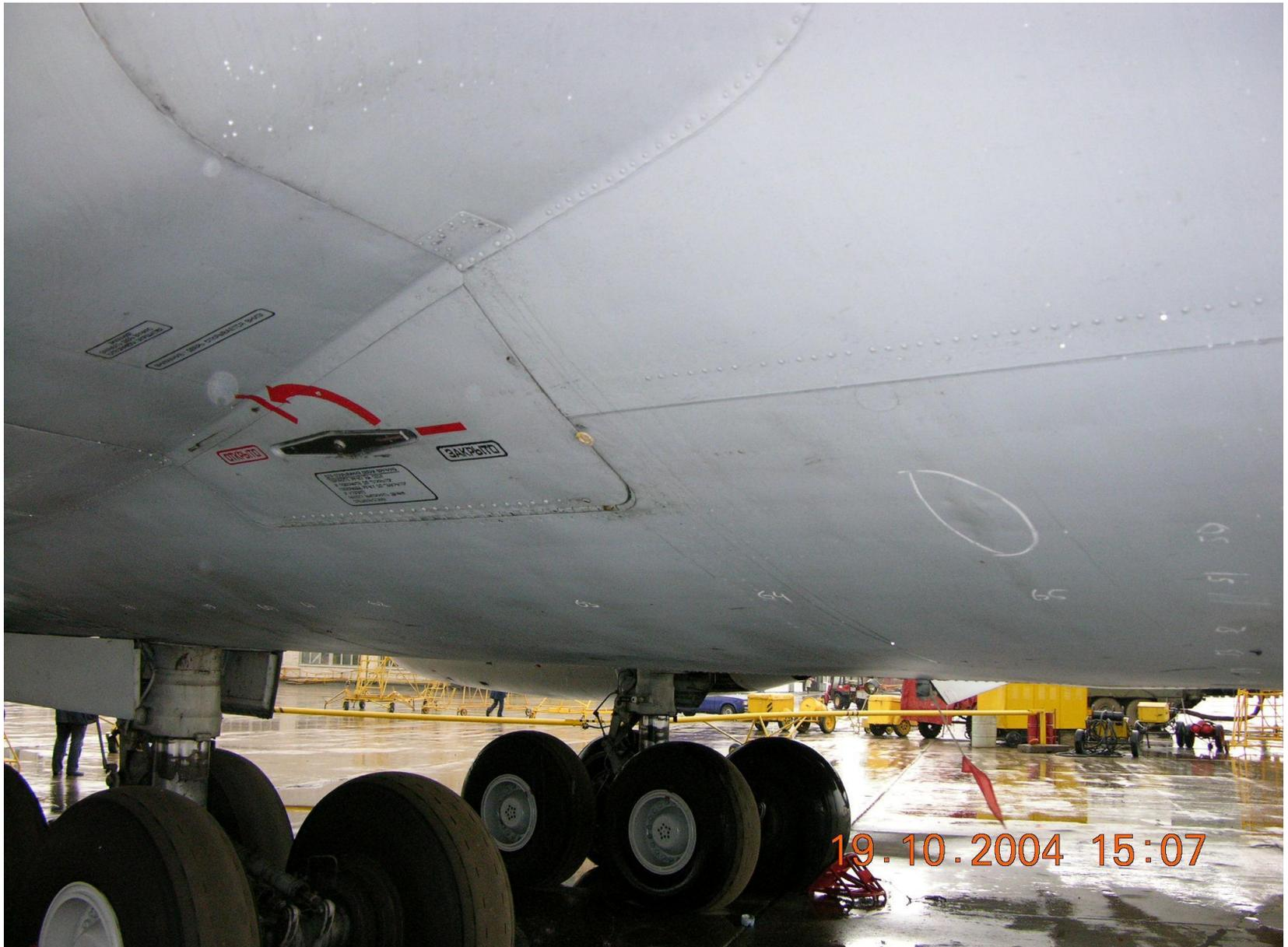
**Рис. Коррозионное повреждение обшивки фюзеляжа**
