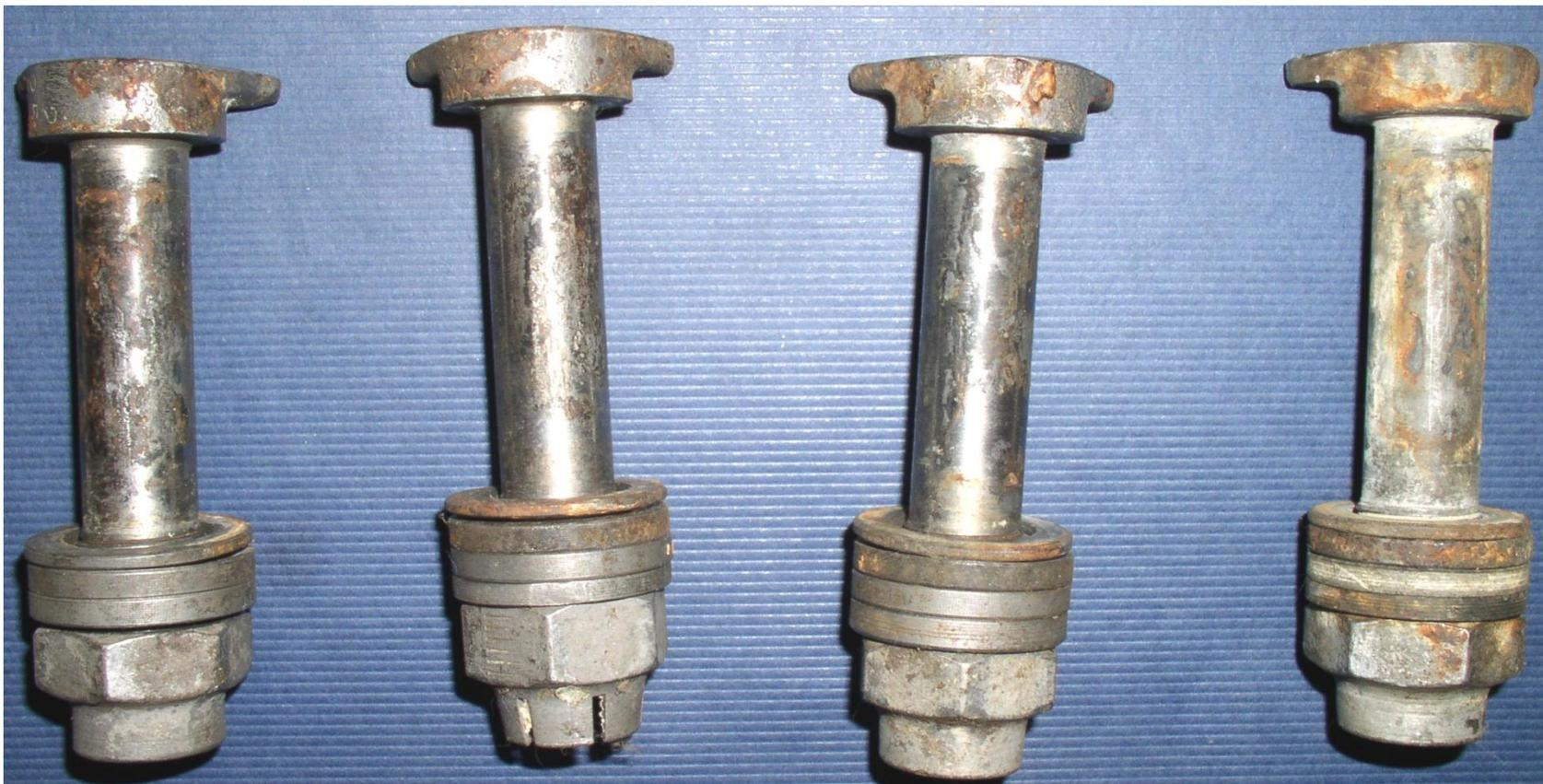
Рис. Коррозия элементов крепежа
