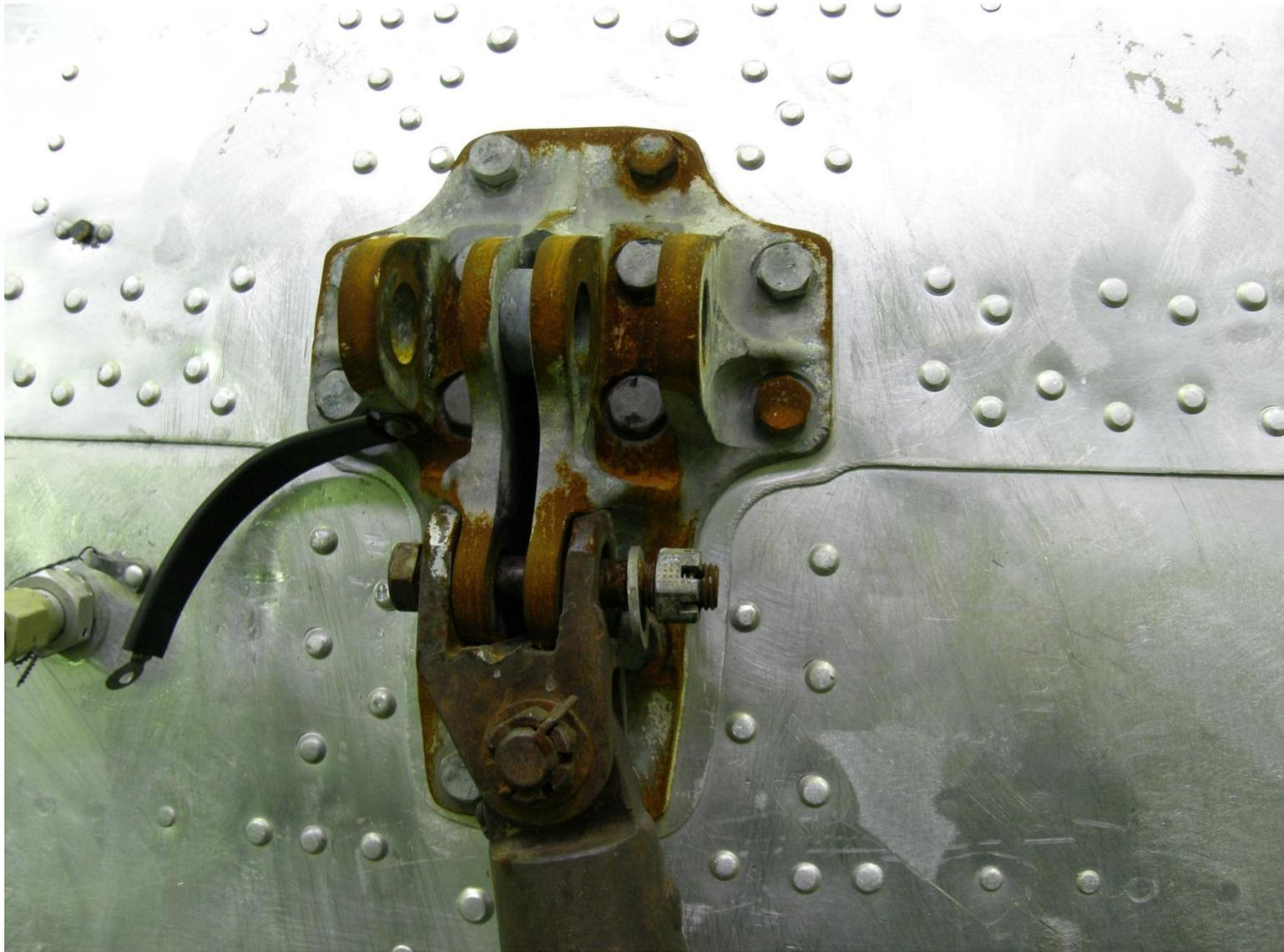
**Рис. Кронштейн крепления амортизационной стойки
