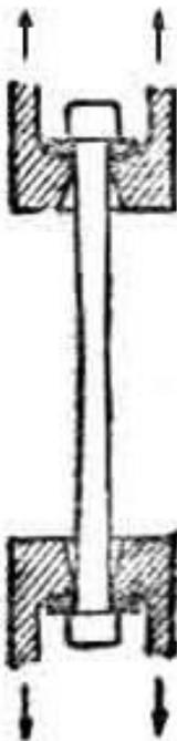
Рис. Схема закрепления образца для испытаний на растяжение
