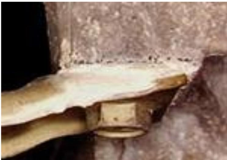
**Рис. Электрохимическая коррозия на границе (в контакте) стального корпуса и кронштейна из магниевого сплава**
