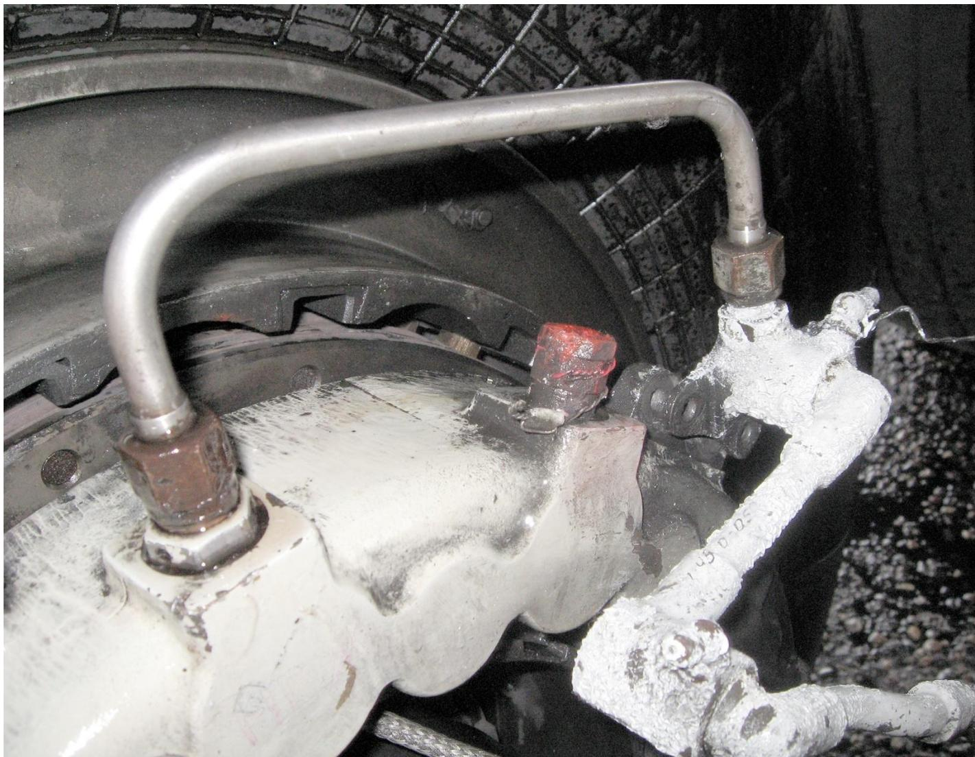
**Рис. Коррозия на узлах системы тормозов колес основной опоры шасси**
