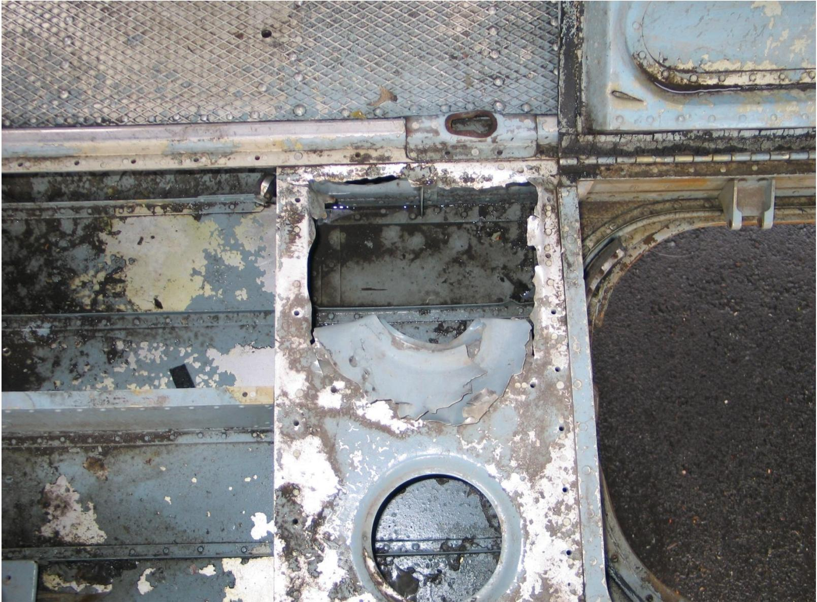
**Рис.        Внутренняя поверхность обшивки фюзеляжа и элементы каркаса в багажном отделении вертолета Ми-8**
