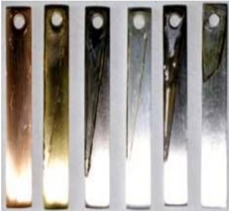
Рис. Разводы на пластинах - следы щелевой коррозии
