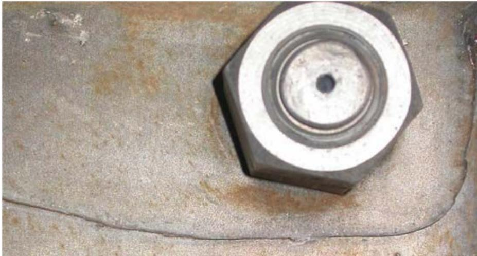
Рис. Пример коррозии под напряжением – коррозионное растрескивание
