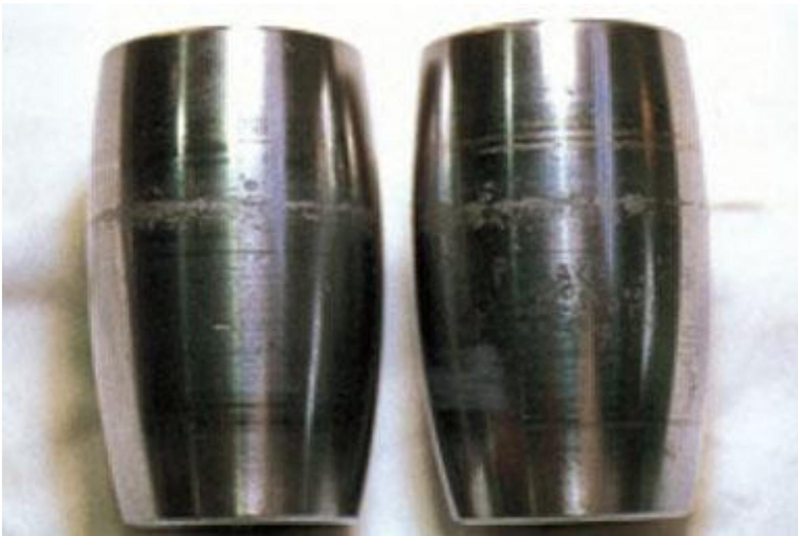
**Рис. Коррозионно-механический износ роликов подшипника**
