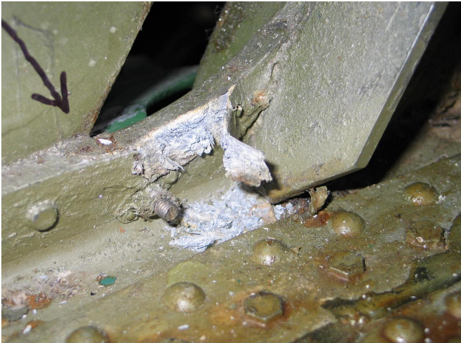
Рис. Расслаивающаяся коррозия стенки верхнего пояса второго лонжерона центроплана шп. № 34 слева (самолет Ту-134А)
