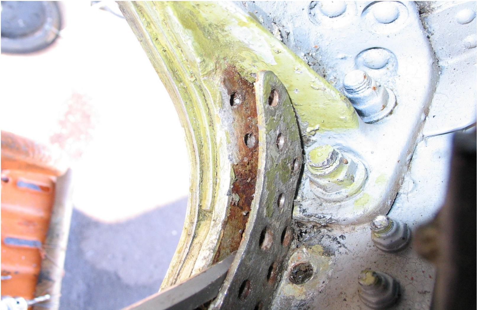
Рис. Коррозия фитинга шп. № 15 справа в нише передней опоры шасси самолета Ту-134А размером 21×8×2,5 мм
