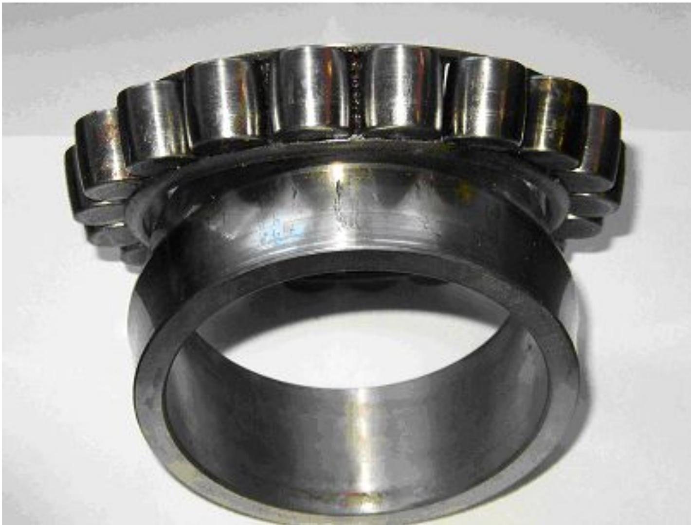
**Рис. Коррозионное поражение деталей роликового подшипника**
