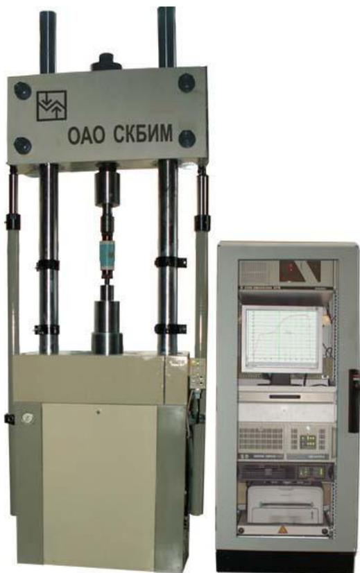
Рис. Разрывная машина для испытания образцов на сопротивление разрыву и на удлинение
