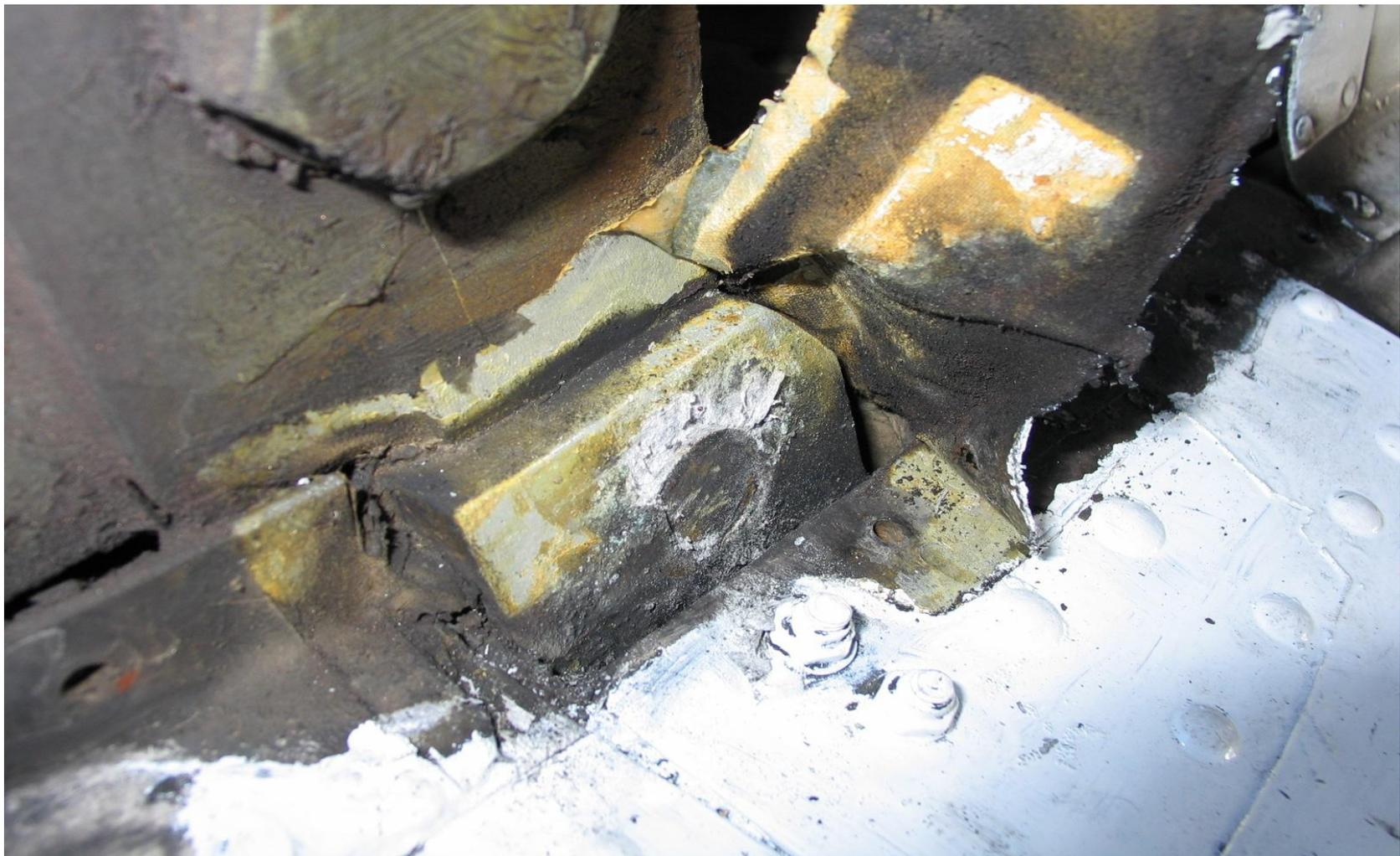
Рис.      Расслаивающаяся коррозия балки шп.№55 в районе
