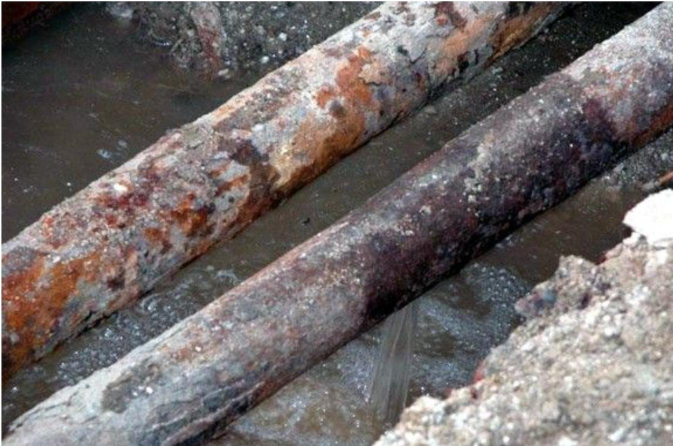
**Рис. Пример коррозии под влиянием грунтовой влаги**
