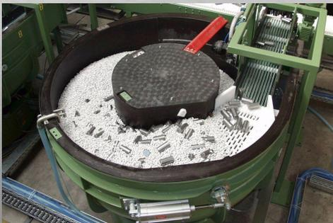
Рис. 9. Оборудование вибрационной очистки
