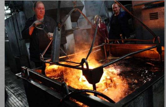
Рис. 8. Процесс охлаждения(заковки)
