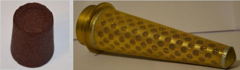
Рис. 13. Сменная часть фильтра после обработки
