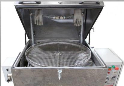
Рис. 10. Оборудование струйной мойки
