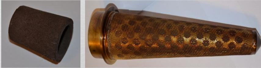
Рис. 12. Сменная часть фильтра до обработки
