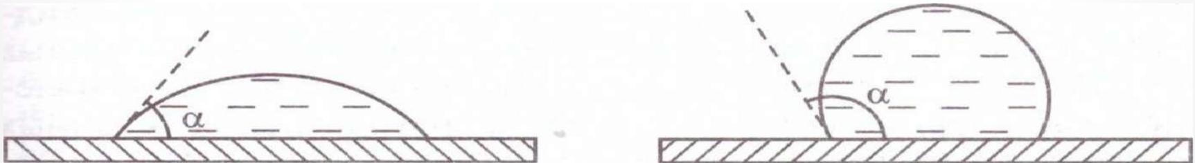
Рис. 1.2. Гидрофильная (а) и гидрофобная (б) поверхности
