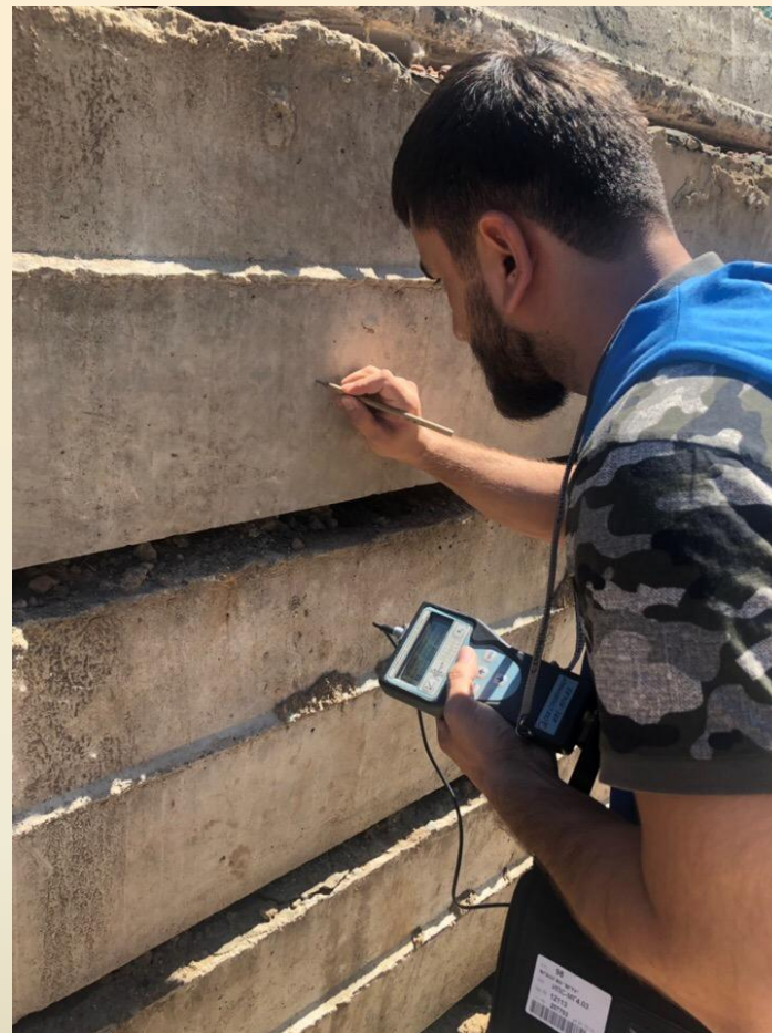
Фото 3. Определение прочности бетона неразрушающим методом контроля сотрудниками кафедры СКОиФ ВГТУ.
