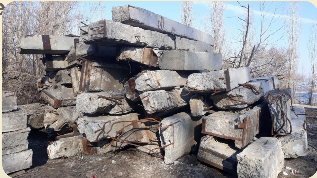
Фото 1. Б/у ж/б колонны, находящиеся по адресу г. Воронеж, наб. М.Горького,115. Класс бетона по прочности В40.
