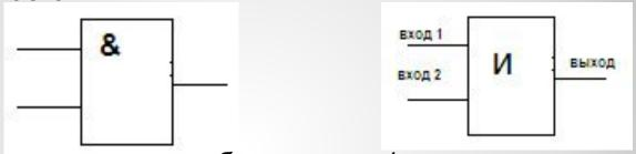
На выходе этого элемента будет сигнал 1 только в том случае, когда на все входы поступает сигнал 1. Когда хотя бы на одном входе будет ноль, на выходе также будет ноль.
