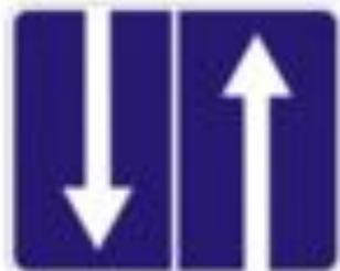
**Знак 5.15.7 "Направление движения по полосам"** – регулирует движение по полосам, обозначает количество полос, а так же направление и режим движения по полосам. Водитель должен двигаться по стрелкам, которые изображены на знаке.
