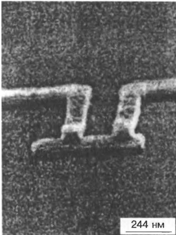
Изображение одноэлектронного транзистора, полученное при помощи СЭМ
