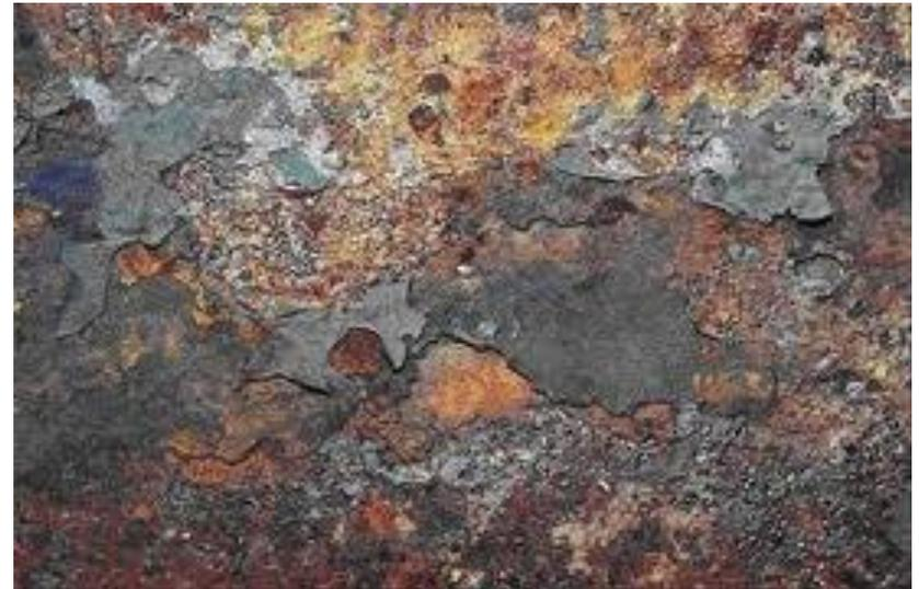
Сухая коррозия (**участок I**) происходит при отсутствии пленки влаги на поверхности металла.
