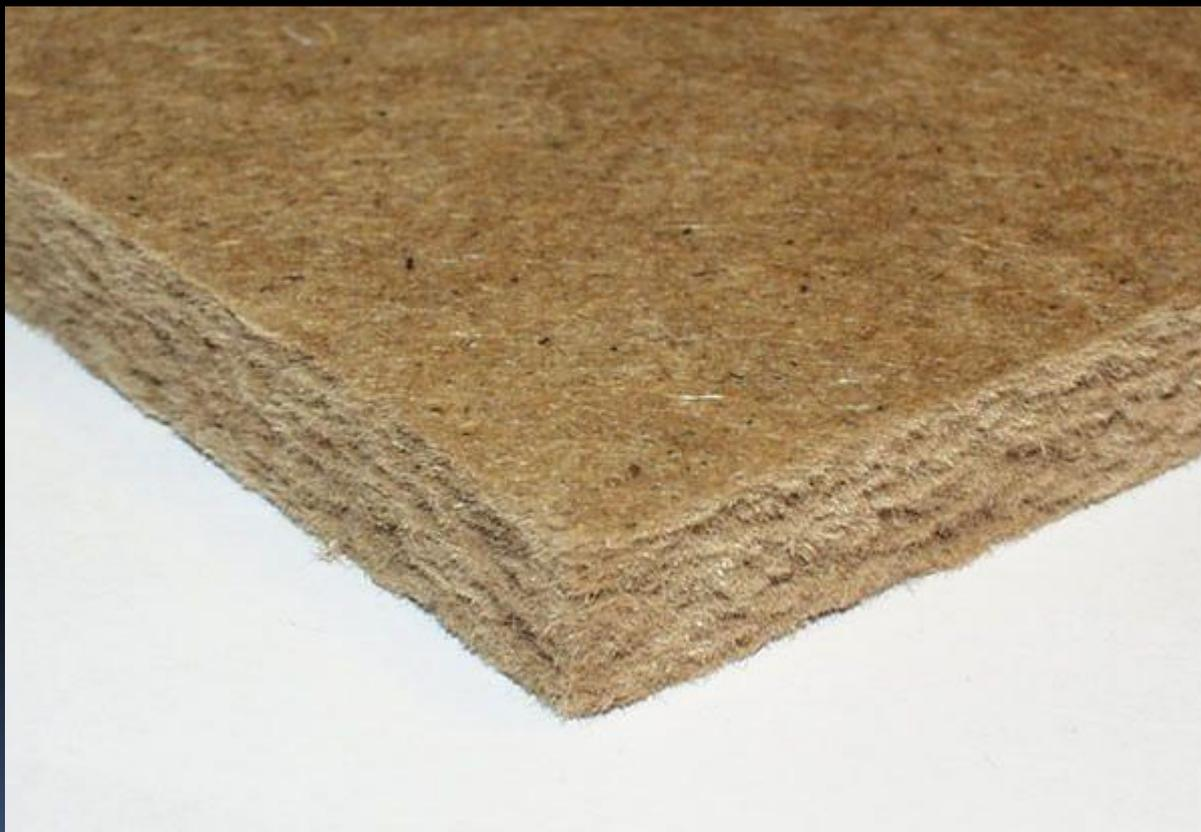
**ДВП полутвердые, по сравнению с мягкими, обладают значительно большей плотностью и твёрдостью и способны выдерживать внушительные нагрузки. Их широко применяют при изготовлении мебельных конструкций: задних стенок, полочек и выдвижных ящиков.**
