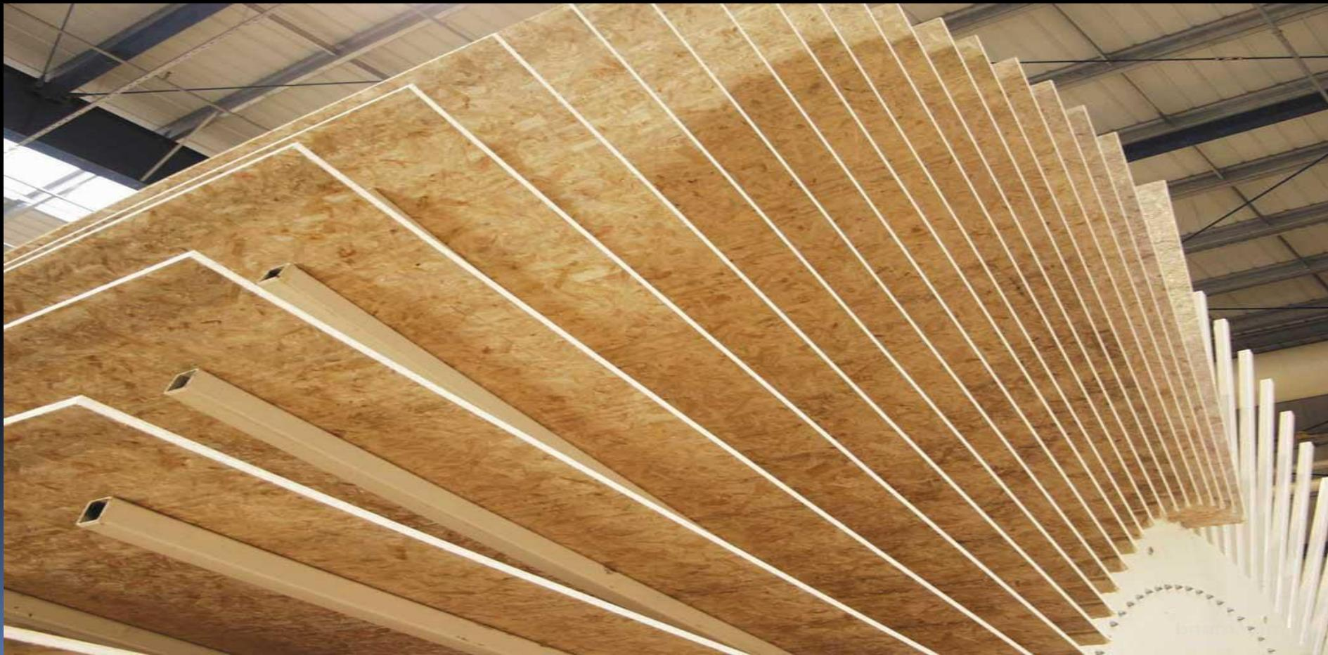
Фанера представляет собой сложный древесноплитный материал, состоящий из листов шпона склеенных между собой. Луцный шпон получают на специальном оборудовании (луцильные станки), которые срезают его с круглой заготовки бревна «чурака». Луцный, используемый при производстве фанеры, производится длиной и шириной от 1,3 м до 3 м. Толщины производимого шпона меняются в зависимости от видов фанеры от 0,3 мм. до 4 мм.
