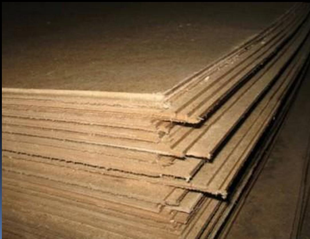
**ДВП мягкие отличаются высокой пористостью, однако, имеют слабую прочность, поэтому не используются как основной материал. Они нашли своё применение в строительстве при монтаже звуко- и теплоизоляционных систем.**
