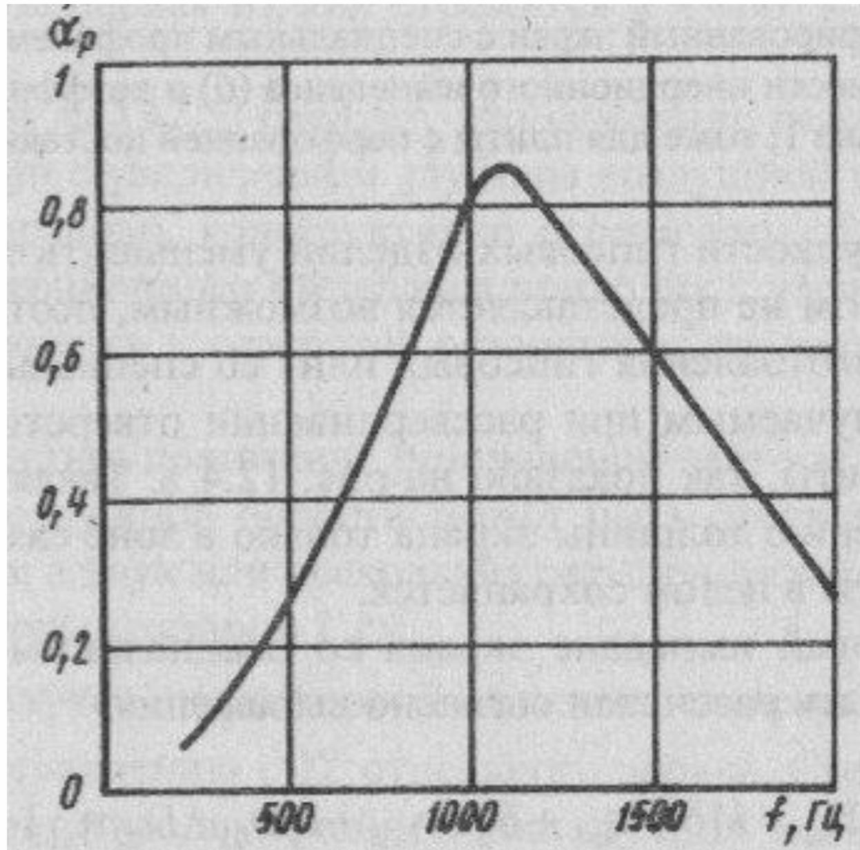
Частотная зависимость коэффициента звукопоглощения двух резонаторов с последовательным соединением
