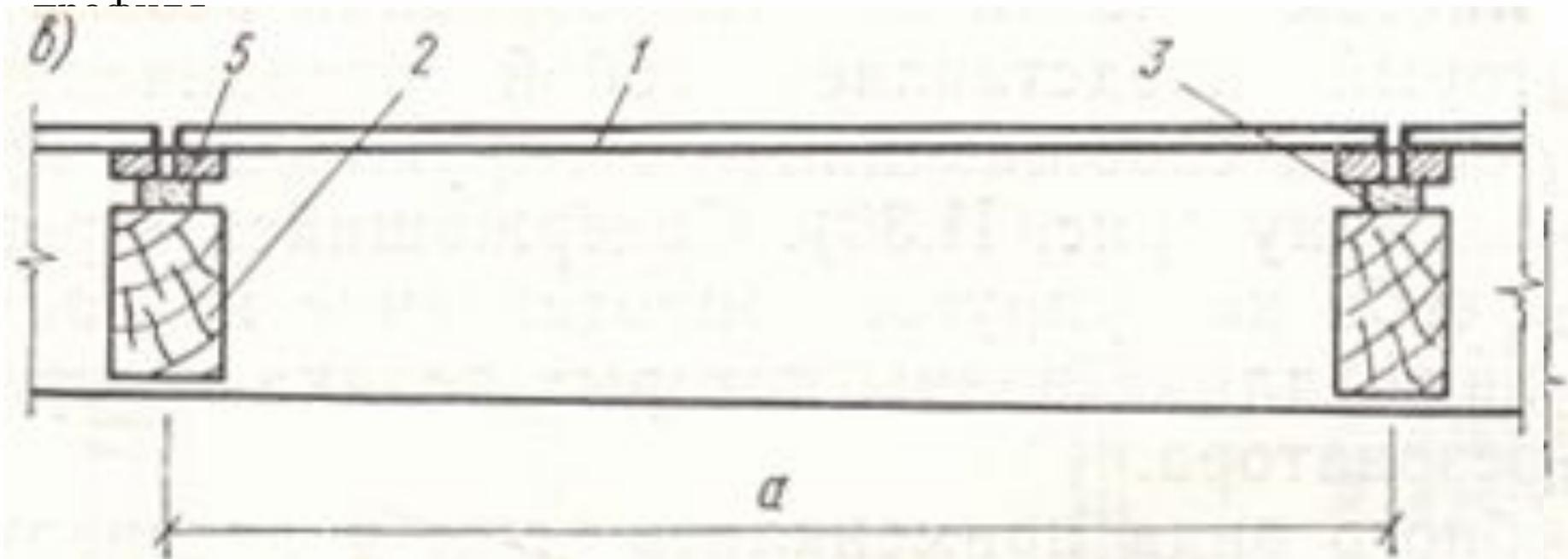
1 – фанера толщиной 10 мм; 2 – деревянный каркас; 3 упругая демпфирующая прокладка; 4 – фанера толщиной 4 мм; 5 – деревянная обвязка, приклеенная к листу фанеры
