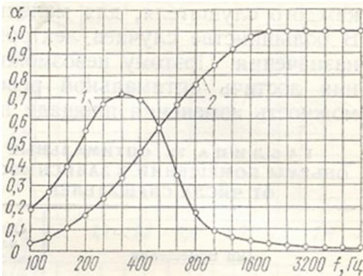
1 – коэффициент поглощения резонаторов в виде обычных и перфорированных плит и резонаторов Гельмгольца;
