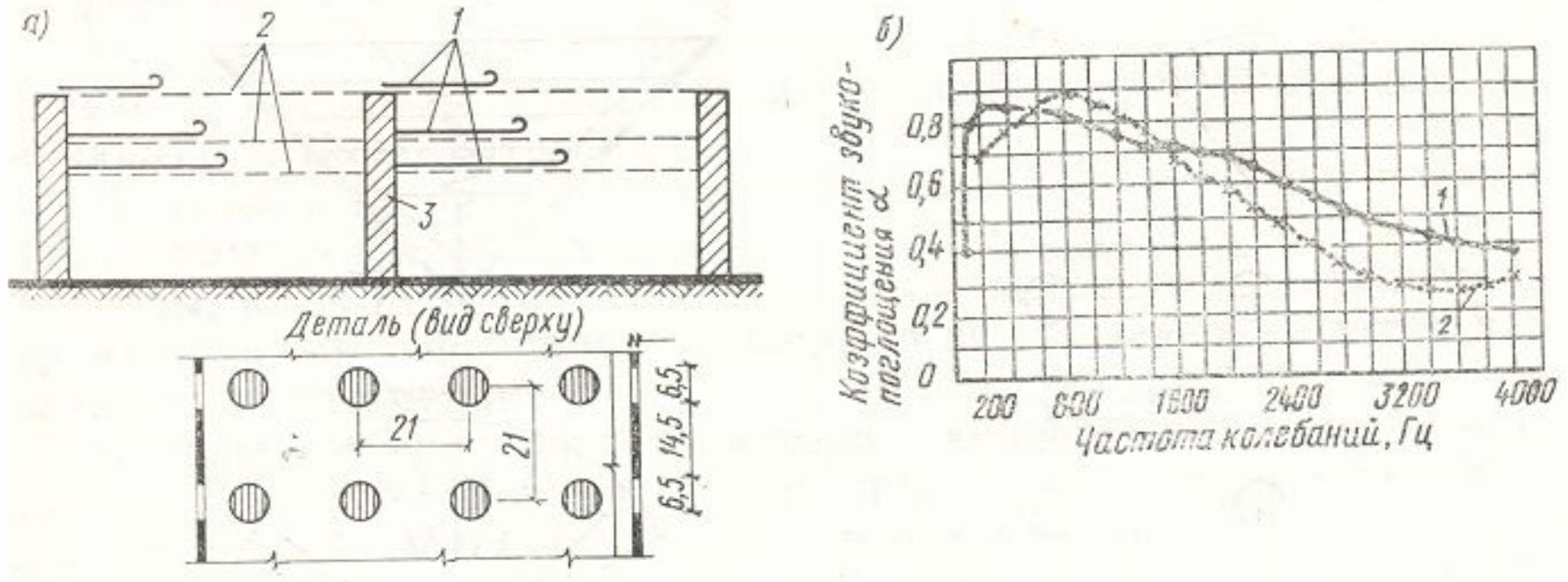
а — конструктивная схема; 1 — наклеенная на лист редкая ткань (срепянка, мешковина и др.); 2 — перфорированный лист оцинкованного железа; 3 — каркас; б — частотная характеристика многослойных конструкций с перфорированным слоем; 1 — расчетная характеристика звукопоглощения; 2 — характеристика звукопоглощения, измеренная в лаборатории
