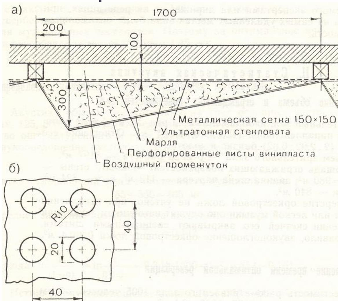
а – сечение звукопоглощающей конструкции;
