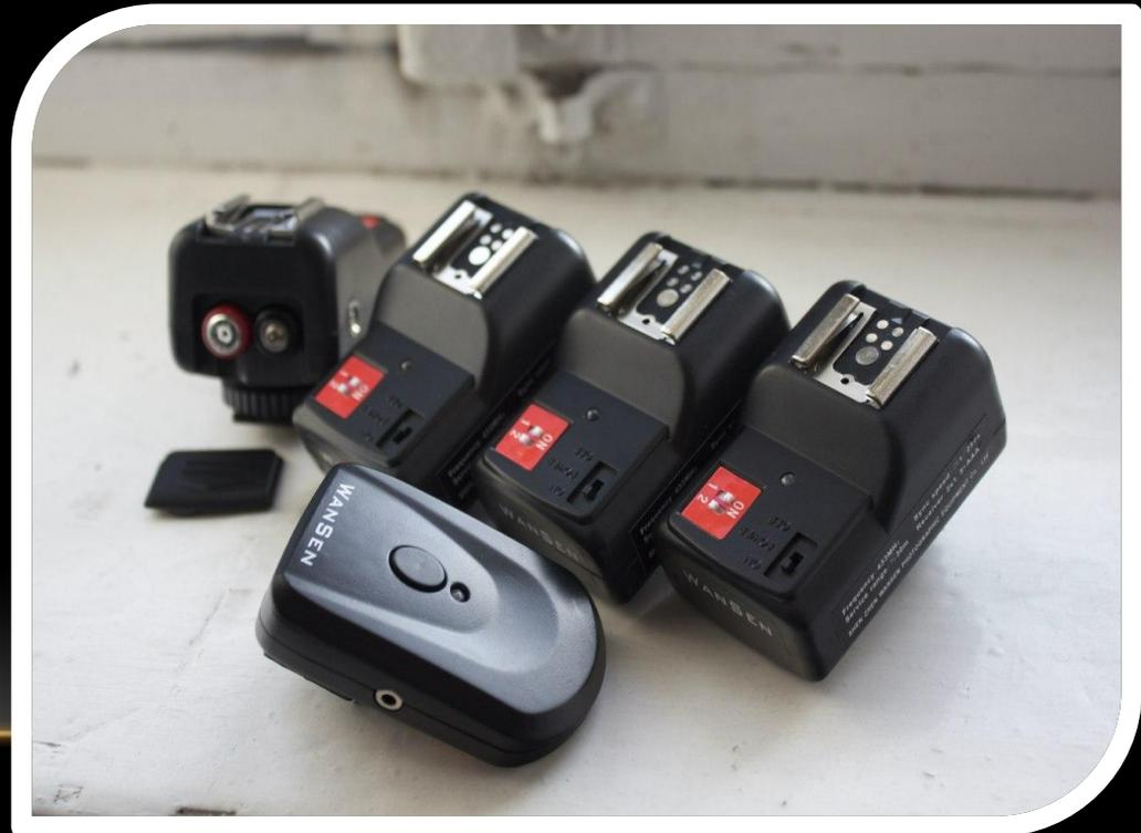
**Радиосинхронизатор с поддержкой TTL** представляет собой передатчик, совмещенный с пультом управления, и приемники для совместимых вспышек. Он позволяет без использования кабелей «поджигать» TTL вспышки, сохраняя в полной мере функции TTL, а также на расстоянии контролировать мощность и фокусное расстояние вспышек.
