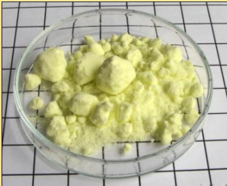
Твердое кристаллическое вещество желтого цвета, нерастворима в воде, водой не смачивается (плавает на поверхности - ФЛОТация),  $t^{\circ}\text{кип} = 445^{\circ}\text{C}$
