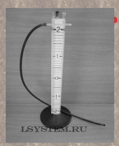
Открытый жидкостный манометр По назначениям манометры можно разделить на технические — общетехнические, электроконтактные, специальные, самопишущие, железнодорожные, виброустойчивые (глицеринозаполненые), судовые и эталонные (аналоговые).
