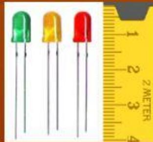
Как и в нормальном полупроводниковом диоде, в светодиоде имеется р-п переход. При пропускании электрического тока в прямом направлении, носители заряда — электроны и дырки рекомбинируют с излучением фотонов.
