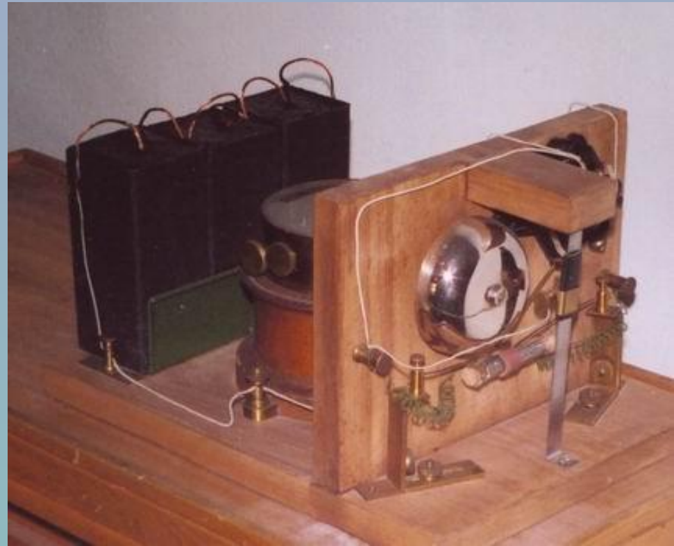
Первый радиоприемник А.С. Попова
