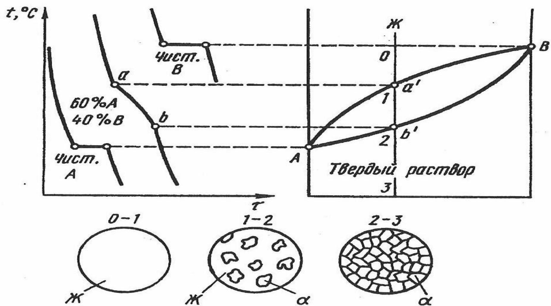
Рис. 13. Диаграмма состояния, кривые охлаждения и схемы образования структур сплавов с неограниченной растворимостью в твердом состоянии
