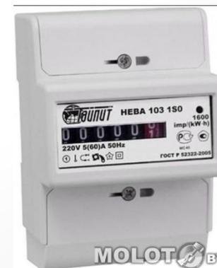
**При превышении мощности** потребителей энергии счетчик выходит из строя из-за перегорания его внутренней электрической цепи или механической поломки механизма.
