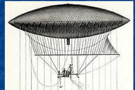
Следующий технологический прорыв был совершён в 1884 г., когда был осуществлён первый полностью управляемый свободный полёт на французском военном дирижабле с электрическим двигателем .
