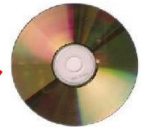
В настоящее время существуют устройства, которые позволяют не только прочитывать **CD-ROM** диск, но и производить однократную запись на "золотой" диск. Такие диски читаются на любом устройстве **CD-ROM**. Однако недавно появились устройства, которые могут производить перезапись оптических дисков (**CD-RW CD-ReWritable**). Такие диски уже не могут быть прочитаны обычным **CD-ROM** плеером.
