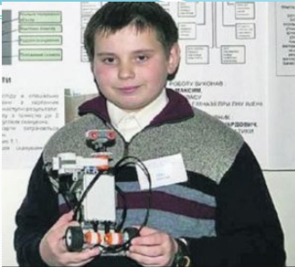
12-летний **Максим Лема** из Львова создал робота, выполняющего функции инженеров БТИ (замерщиков). Робот сканирует помещение, замеряет площадь, составляет план и с помощью радиосигнала передает данные на компьютер.
