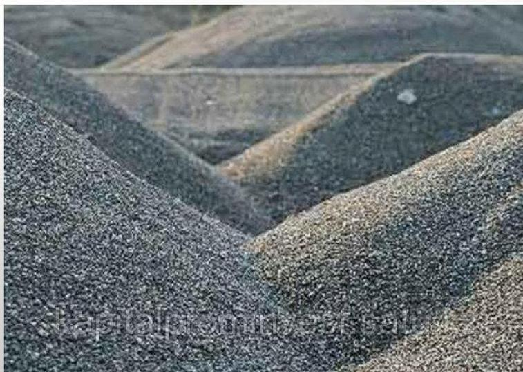
❖ Щебень аглопоритовый (ГОСТ 11991—66), получаемый при термической обработке силикатного сырья методом агломерации;
