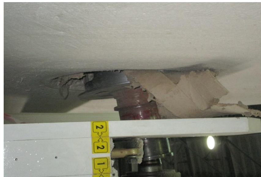
Гильза разрушилась, вставку заклинило
