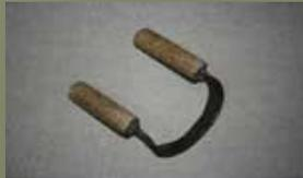
**Бондарная скоба** или **скобель**, представляет собой скобу с прямым или дугообразным лезвием. На изогнутые концы насажены две деревянные ручки. В бондарном ремесле этот инструмент использовали для продольного строгания клёпок.
