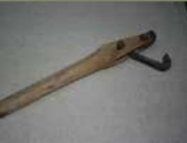
С помощью **натяга** надевают на остов бондарной посуды металлические или деревянные обручи. Он состоит из деревянного бруска с рукояткой на одном конце и металлическим концом – на другой. При надевании на бочку или кадку обруч закрепляют крюком, а торец деревянного бруска упирают в край посуды.
